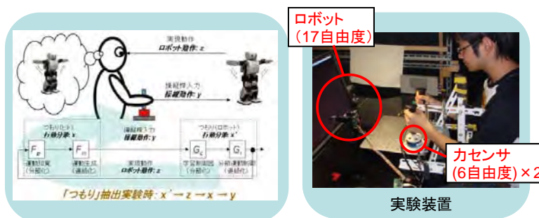
図 阪大-5 「つもり」の抽出によるロボット操縦支援実験
