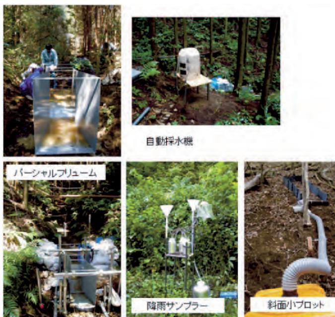
図-3 観測設備の概況
