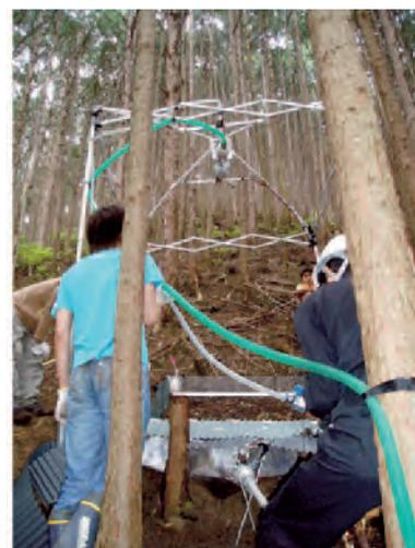
図-12 振動ノズル散水装置による現地実験の様子
