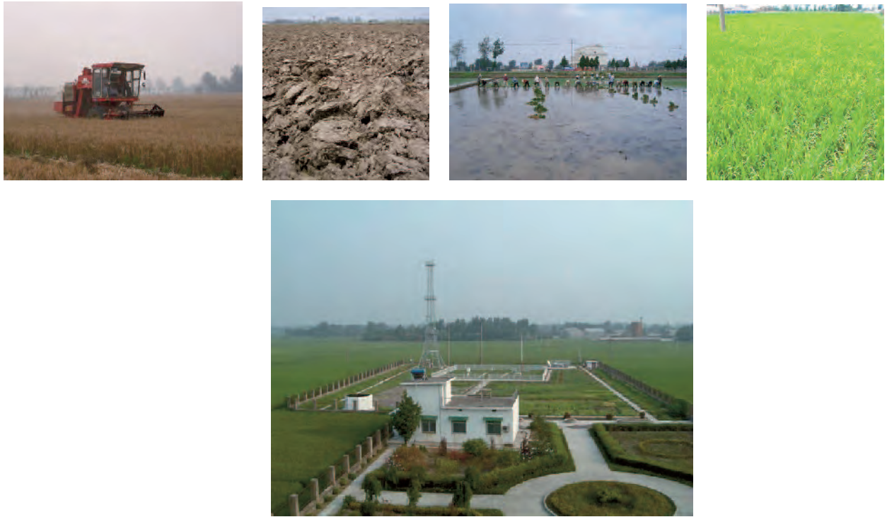
図2 中国観測点における地面状態の季節変化（小麦畑～裸地～水田）と観測施設。 30m フラックス観測タワー、ウィンドプロファイラ等を設置した。
