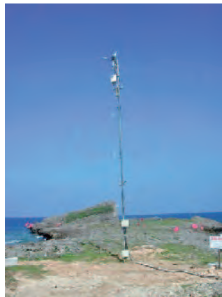
図3 南西諸島における大気境界層観測。Aerosonde、ドップラソダ、ゾンデ飛揚、マストによるフラックス観測、雲のビデオ撮影、等を行った。
