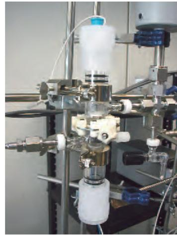
図2 水凝縮型固体高分子電気分解装置の開発。極微量の水安定同位体比の測定が可能である。
