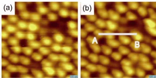
図9 像観察-スペクトロスコピ-ドリフト補正のサイクルを繰り返した観測での像の変化。(a)(b)の像観察には約2時間経過している。
