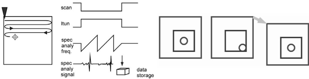
図7 像観察と表面特定サイトにおけるスペクトロスコピー取得の模式図。実際には図8で説明するドリフト補正を加えて、サイクルを繰り返す。
