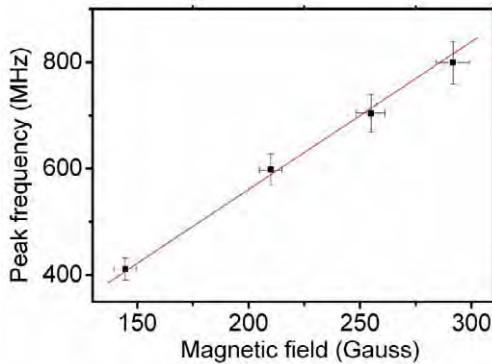
図5 ピーク位置の磁場強度依存性。図4で示した信号の磁場依存性。
