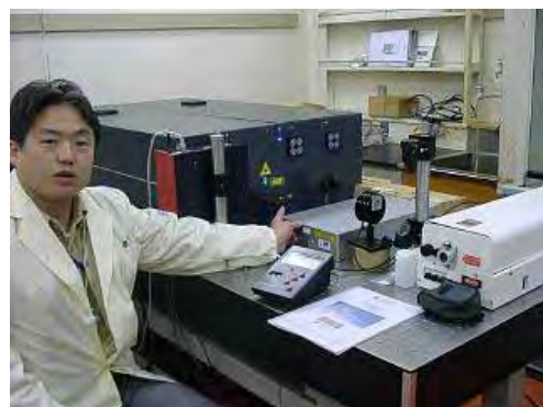
図5 最適イオン化条件探査のための超短パルスレーザーシステム
