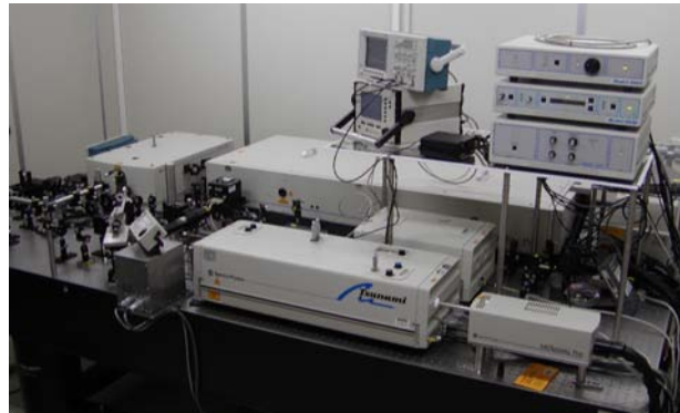
図1 レーザーブース内に設置されたフェムト・ピコ秒パルスレーザーシステム
