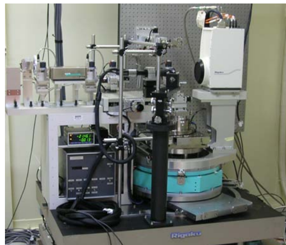
図2 BL40XUに導入された精密回折計
