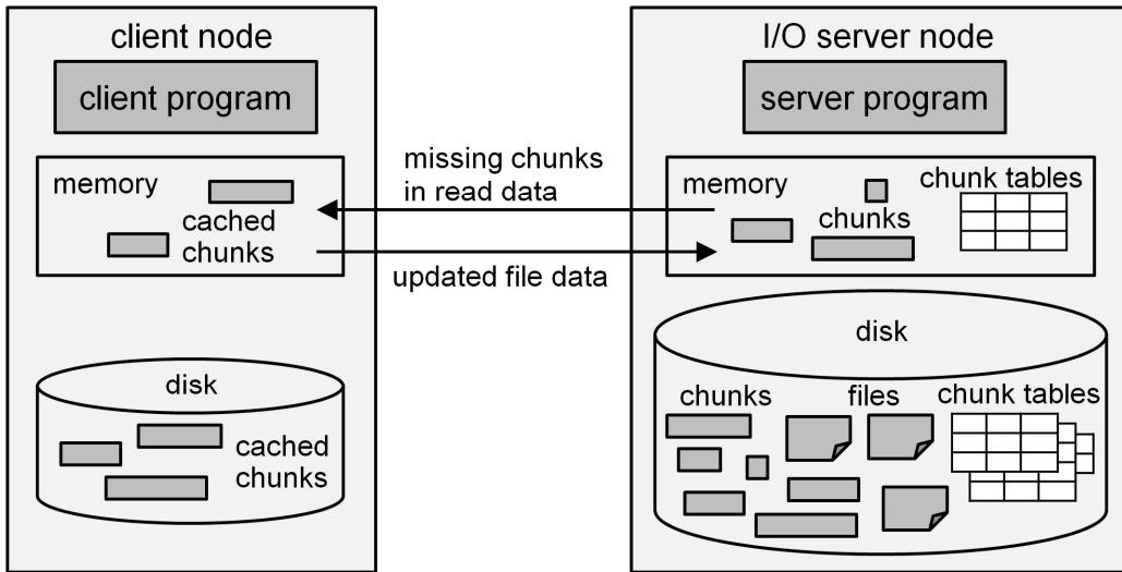
図9. 重複除外を用いたクライアントキャッシュ機構の構成
