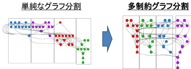
図 6. 多制約グラフ分割による並列性を保ちデータ移動を最小化するスケジューリング
