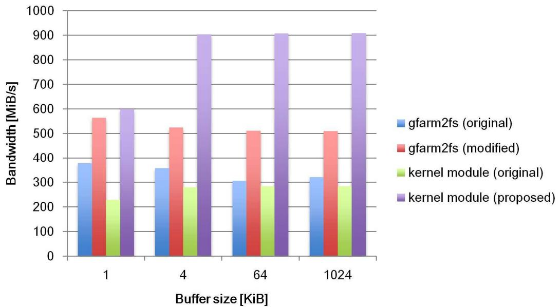
図 8. IOR sequential read ベンチマークを用いて測定した、分散ファイルシステムのサーバからクライアントへのファイル転送性能(カーネルドライバの使用の有無や InfiniBand RDMA の使用の有
