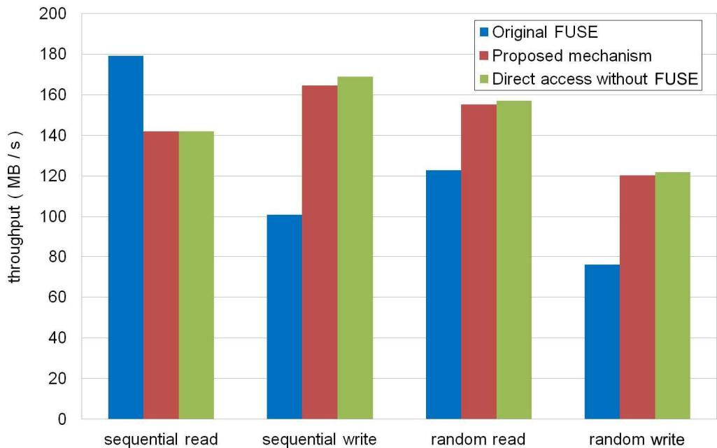
図 7. IOZone ベンチマークを用いて測定された、ローカルストレージに存在するファイルへのアクセスの性能
