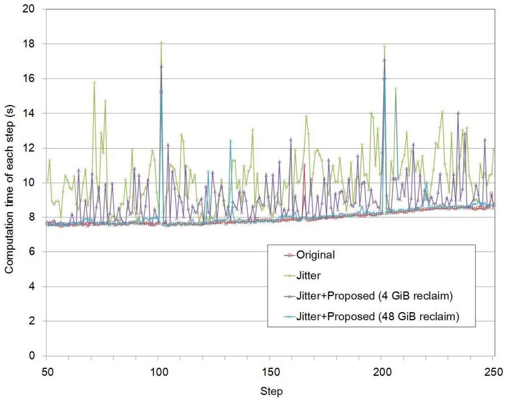
図11. OS ジッタを生じさせるプロセスや提案機構が存在する設定と存在しない設定の下で測定した、気象予測アプリケーション WRF の各ステップの実行時間
