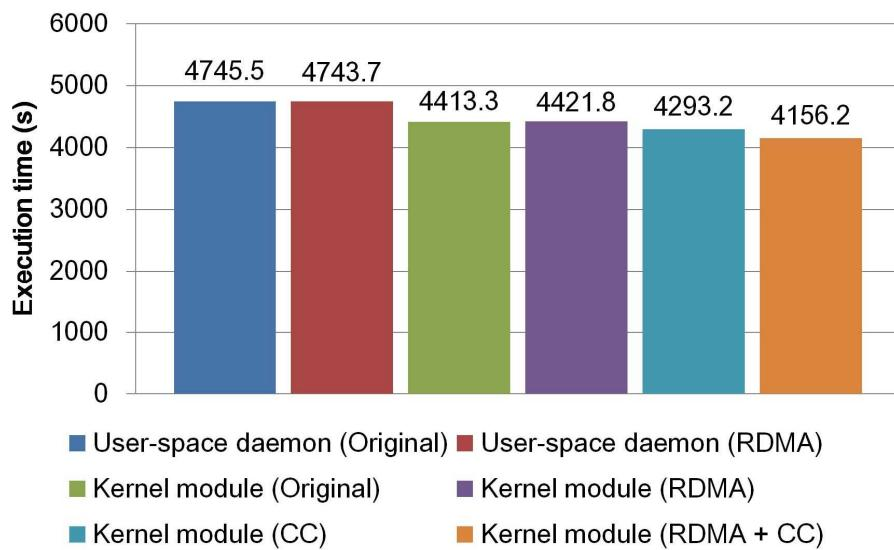
図 10. RDMA による高速ファイルデータ転送機構および協調キャッシング機構に関する設定を変化させて測定した、Montage ワークフローの実行時間
