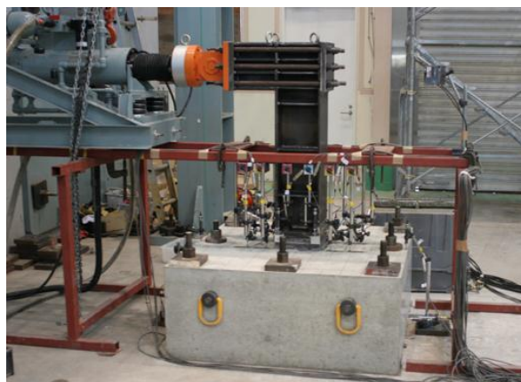
図 23. 建屋・機器接合部位の載荷実験.
