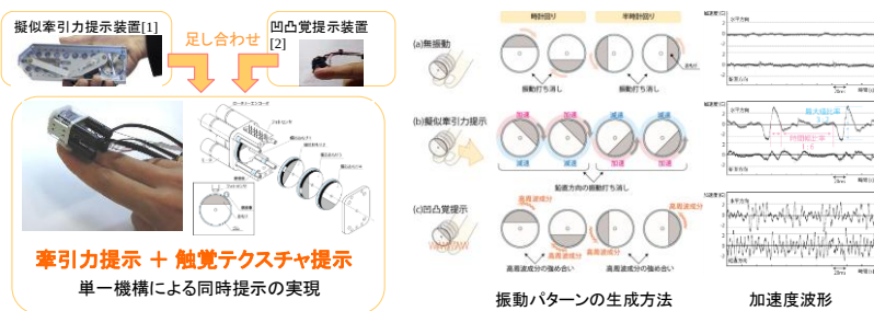
図 阪大-7 牽引力／凹凸覚を提示する爪装着型触覚提示デバイス
