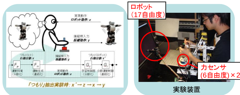
図 阪大-11 「つもり」の抽出によるロボット操縦支援実験
