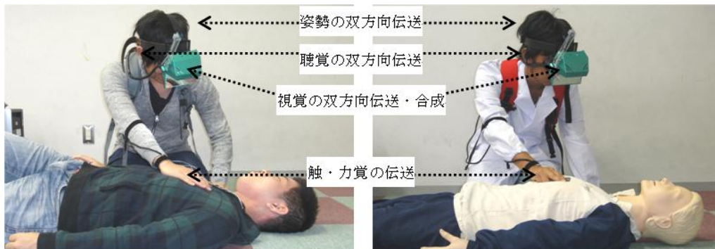
図 阪大-12 「119 番的状況における PH の感覚伝送による作業支援」を実現する構成
