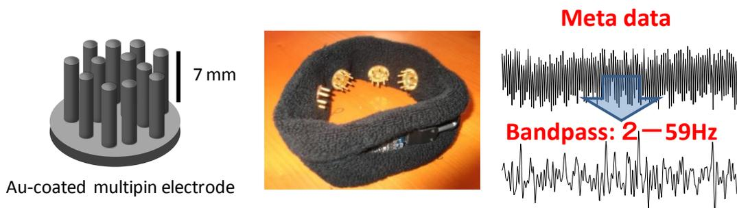
図6 マルチピン型ドライ電極による脳波検出例
