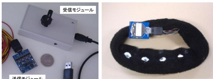
図7 ギガヘルツ帯トランシーバ(2.4GHz)を用いたワイヤレス脳波センサー基板とそれを組み込んだヘアバンド型脳波センサー(プロトタイプ)
