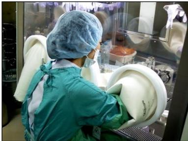
図 2. アイソレーター内でのナノ粒子の製造風景
