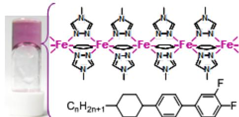
図 3 一次元  $\text{Fe}^{\text{II}}(\mathbf{1})_3\text{Cl}_2$  錯体による LS 液晶ゲルの形成<sup>A-29)</sup>
