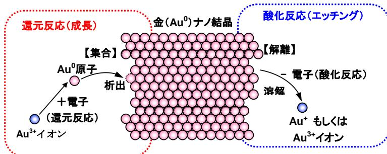
図 13 ナノ彫刻法の概念。<sup>A-31)</sup> Au<sup>3+</sup>の還元反応による Au 結晶の生長と酸化溶解反応(エッティング)を共存させ、化学反応を伴いながら原子が集合・解離する“自己組織化”プロセスを実現することによって、動的なナノ界面構造が生み出される。
