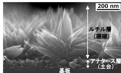
図26  $TiO_2$  ナノコーラルの断面
