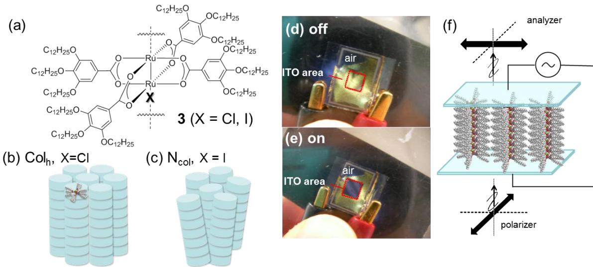
図4 (a) 脂溶性 MMX 型ハロゲン架橋金属錯体 **3**(X=Cl, I) (b)ヘキサゴナルカラムナー(Col<sub>h</sub>)相(X=Cl), (c)カラムナー・ネマチック(N<sub>col</sub>)相(X=I), (d,e)**3**(X=Cl)デカン溶液を ITO 電極に挟んだ試料の写真(クロスニコル下)(d)交流電場無印加時 (e)交流電場(0.8 V  $\mu\text{m}^{-1}$ , 100Hz) 印加時。赤枠線内は ITO 電極部位。(f)交流電場印加時における**3**(X=Cl)の誘電配向模式図 A-11)
