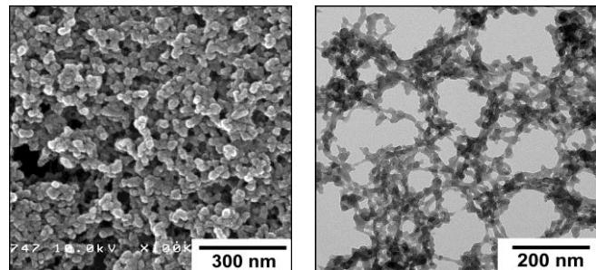
図 8 5'-GMP/Tb<sup>3+</sup>ナノ粒子の SEM (左) ならびに TEM (右) 写真<sup>A-33)</sup>
