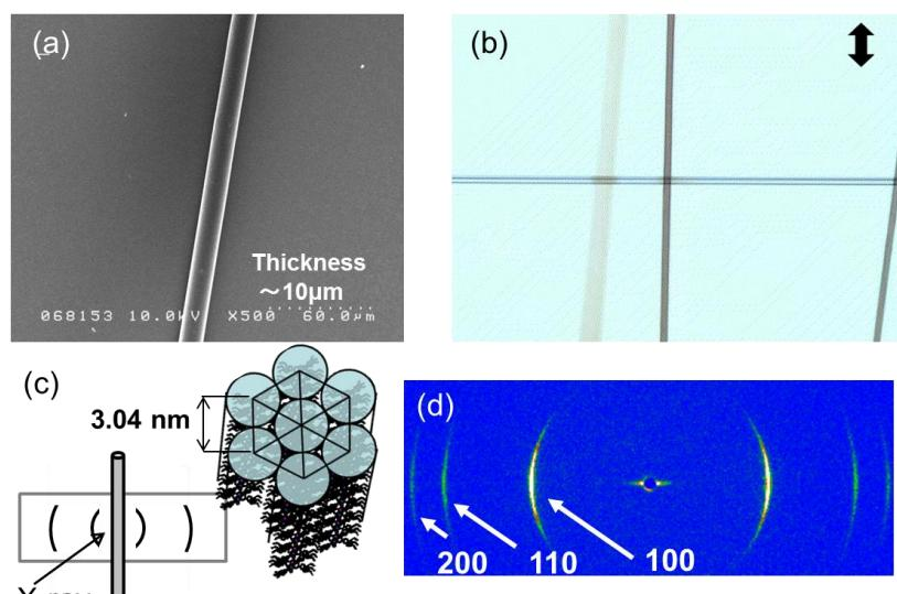
図5 (a) ハロゲン架橋金属錯体 **3**(X=Cl)  $\mu$  ファイバーの SEM 像 (b)偏光顕微鏡写真(二本の  $\mu$  ファイバーが直交) (c)  $\mu$  ファイバーの小角X線測定(SAXS)模式図 (d)  $\mu$  ファイバーの小角X線回折像
