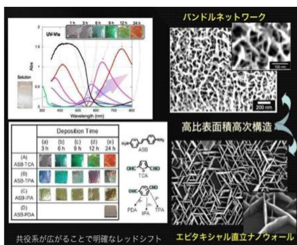
図 19 化学液相成長法で作成した  $\pi$  共役有機超薄膜 <sup>A-4)</sup>
