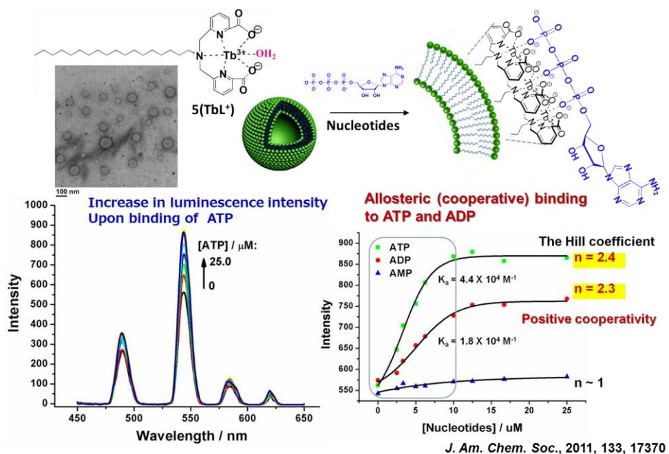
図 12 両親媒性 Tb<sup>3+</sup>錯体 **5** の自己組織化ナノインターフェースの形成と分子情報変換 <sup>A-12)</sup>
