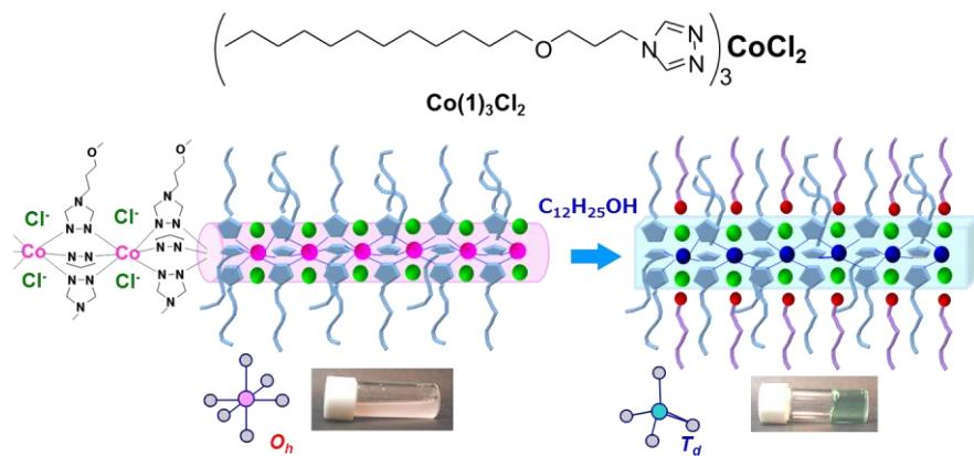
図1 一次元  $\text{Co}^{\text{II}}(\mathbf{1})_3\text{Cl}_2$  錯体表面へのゲスト結合により誘起される配位構造変化の模式図<sup>A-40)</sup>
