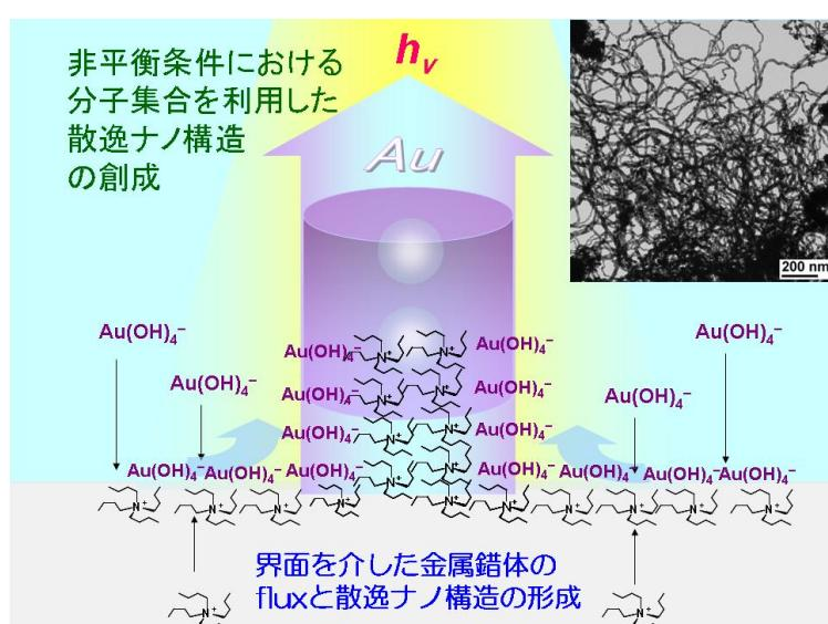
図 15 界面における散逸ナノ構造の形成と光固定化 <sup>A-32)</sup>
