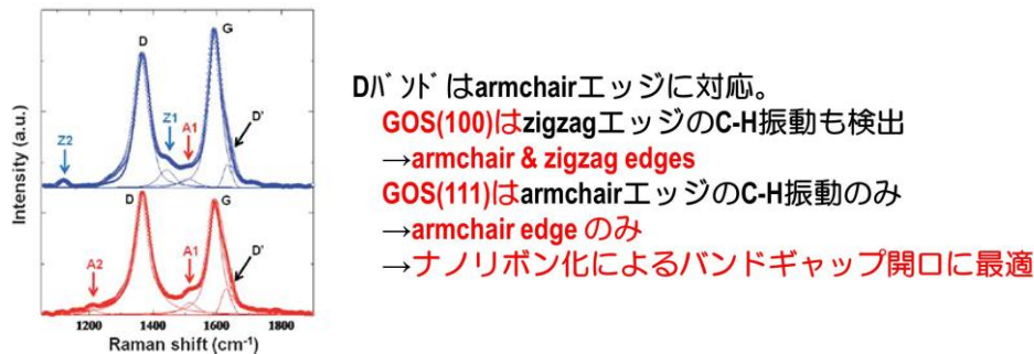
図 4.1.9 GOS の基板面方位に対するエッジ終端の依存性。3C-SiC(111)/Si(111) 上 GOS からのラマン散乱スペクトル（下）は、アームチェア（ac）エッジ起因の D バンドに加え、ac エッジ炭素の C-H 振動に起因する A1 および A2 バンドが観察されることから、ac エッジが支配的であると分かる。これに対し、3C-SiC(100)/Si(100) 上 GOS からのスペクトル（上）は、D、A1、A2 に加えてジグザグ（zz）エッジ炭素の C-H 振動に起因する z1、z2 モードが観察されることから、ac、zz 両方のエッジが混在していることが分かる [61]。
