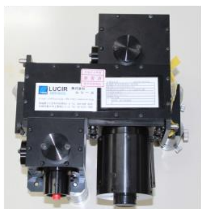
図: 極微細蛍光内視鏡先端部 (上) と専用の光学系 (下)
