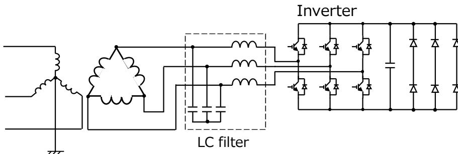
図 3.3.5 インバータ実験回路
