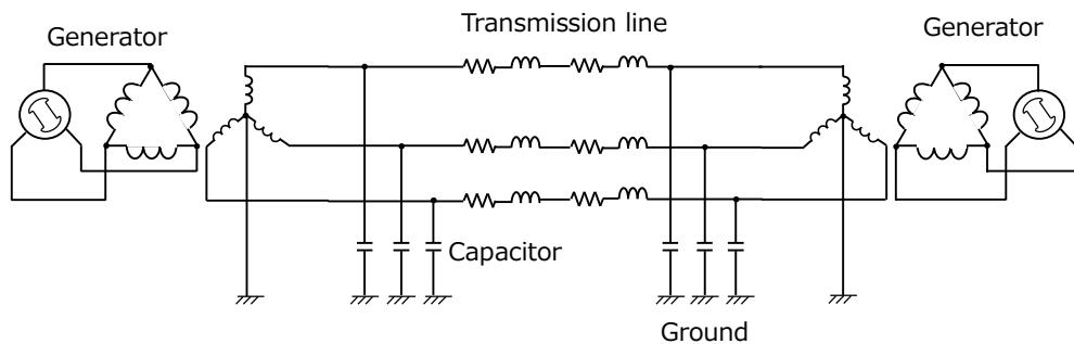
図 3.3.4 拡張した実験環境(発電機二機)
