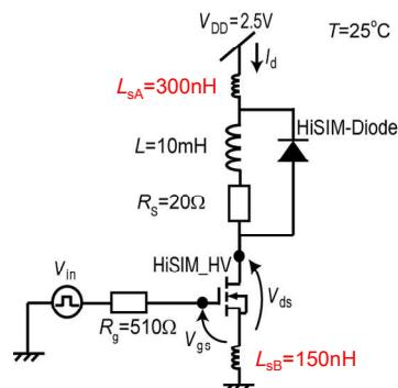
図 3.1.1 誘導負荷スイッチングテスト回路
