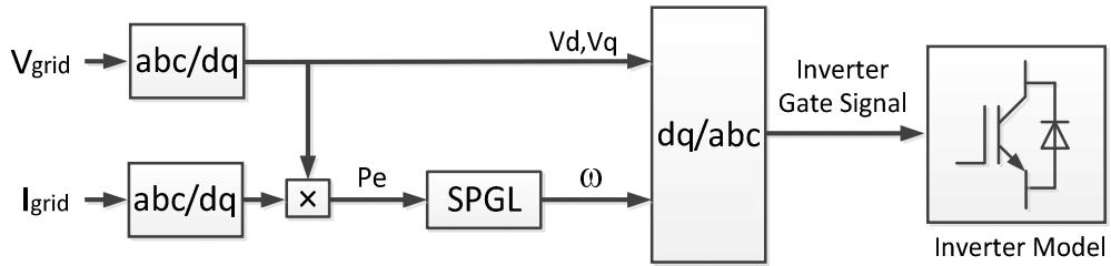
図 3.2.4 インバータモデルへの SPGL の実装
