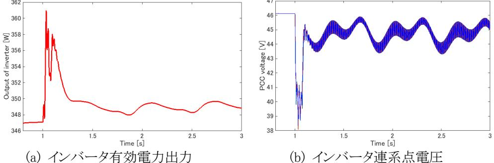
図 3.3.3 疑似同期化力機能を搭載したインバータの事故時挙動(慣性定数: 大)
