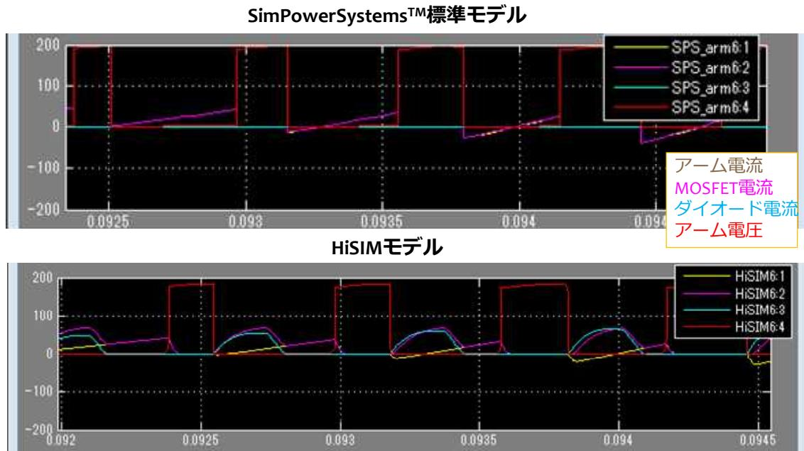
図 3.1.10 PCS 内のインバータ部1アームの電流・電圧波形の拡大図
