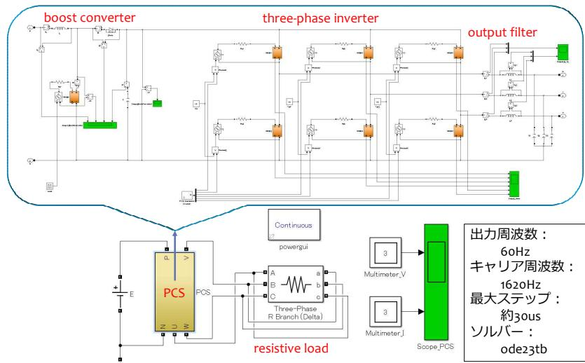
図 3.1.7 PCS のブロック線図(上段は PCS のサブシステム内部)
