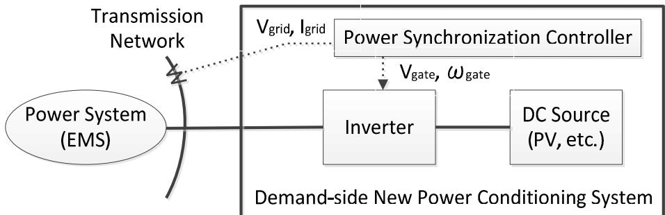
図 3.2.2 電力システム(EMS)における疑似同期化力インバータの位置付け
