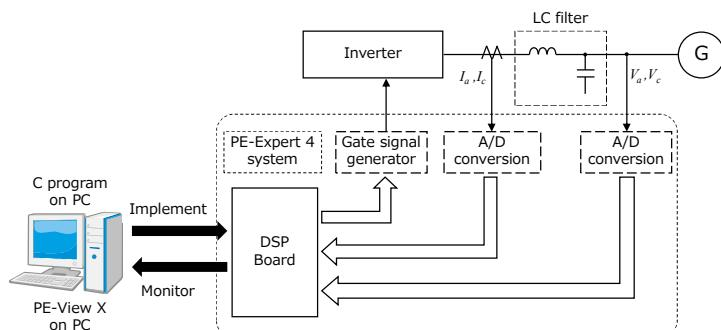
図 3.3.7 インバータのデジタル制御システム
