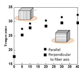
図5 GO/PVA多孔性複合体の異方的熱伝導性
