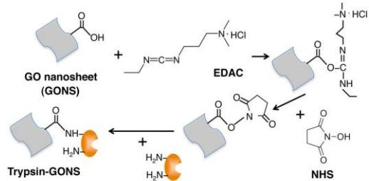
図1 活性エステル化法による GO へのトリプシンの固定化
