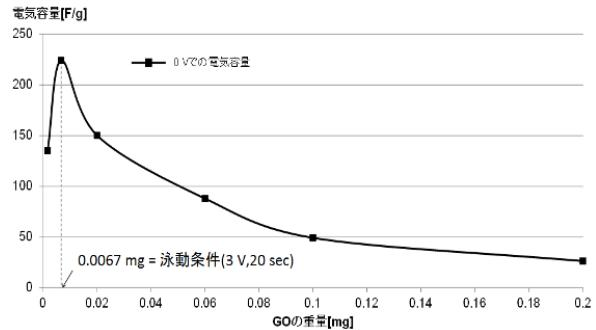
図2 Ce<sub>x</sub>/GO 電極の重量と電気容量の関係
