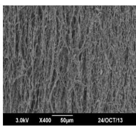
図3 热傾斜凍結乾燥法で作製したPVA多孔体
