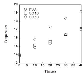
図4 GO/PVA多孔性複合体の熱伝導性に及ぼすGO濃度効果
