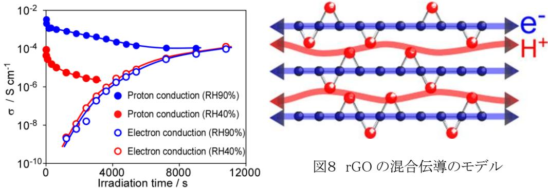
図7 還元に伴うプロトン伝導度と電子伝導度の変化
