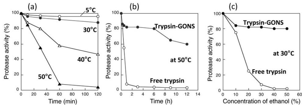
図2 固定化およびフリーの trypsin の酵素活性維持能の比較 ((a) フリーの trypsin の酵素活性に及ぼす温度の影響, (b) 温度と酵素保存時間の影響, (c) エタノールへの保存時間の影響) (フリー trypsin の初期活性:3,600 unit/mg at 30°C, 酵素 Sample 1 mL (フリー trypsin 100 ug/mL, 固定化 trypsin 100 ug/mL as trypsin-GONS, 153 ug/mL as trypsin-GONS)
