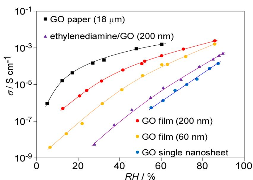
かのチェックを重水を用いて行った。その結果、重水による湿度の元では軽水の湿度の場合に比べて伝導度が減少し、プロトン伝導であることが判明した。さらにプロトン伝導の膜厚依存性を測定したところ、シングルナノシートの場合には、マルチに比べてプロトン伝導度が著しく低く、プロトンが GO ナノシート層間を移動していることが分かった。さらに、エポキシ基が消滅するエチレンジアミン修飾を行った場合も、例えマルチであっても同様に減少した(図6)。結論として、プロトンは GO 多層膜の層間のエポキシ基を介して移動していると結論できた。
