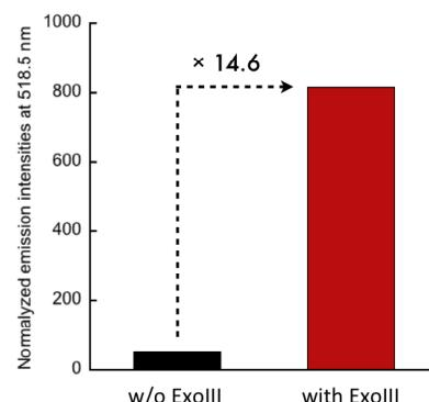
図4 ExoIII によるターゲットのリサイクルを利用したシグナル増幅 ExoIII は平滑末端、または 5' 突出末端を持つ二本鎖 DNA の 3'-OH 末端から段階的にものヌクレオチドを除去する。ターゲットがリサイクルされた結果、鎖交換に基づくシグナルをさらに約 15 倍増幅することができた。
