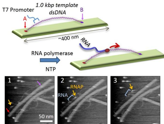
図 3.1-C. 転写の1分子観察のための DNA ナノ構造体。テープ状の構造体上に転写の鋳型となる約 1000 塩基対の 2 本鎖 DNA を 2 か所で結合する。AFM イメージでは RNA ポリメラーゼが鋳型 DNA 上を RNA を合成しながら動く様子を捉えている。走査速度:0.2 フレーム/秒。
