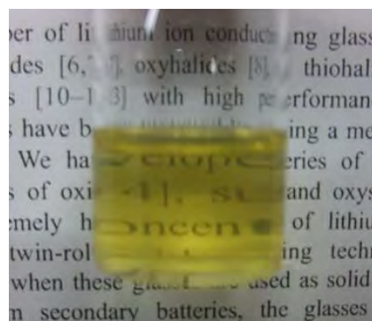
図 29. 80\text{Li}_2\text{S}\cdot 20\text{P}_2\text{S}_5 ガラスの NMF 溶液.
