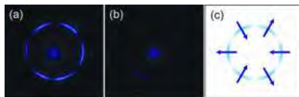
図 8 発生した第 2 高調波の強度分布。(a)および(b)は基本波がそれぞれ方位および径偏光の場合。(c)は偏光と位相、強度分布の模式図。
