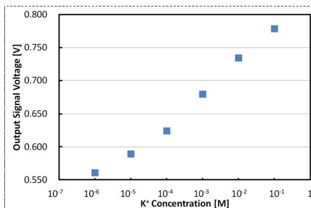
図 2-1 カリウムイオンセンサの感度
