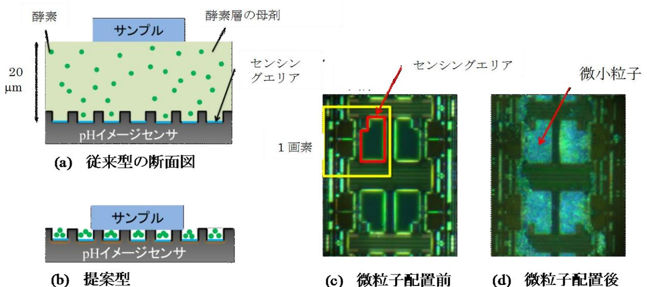
図3-5 アセチルコリンセンサの構造
