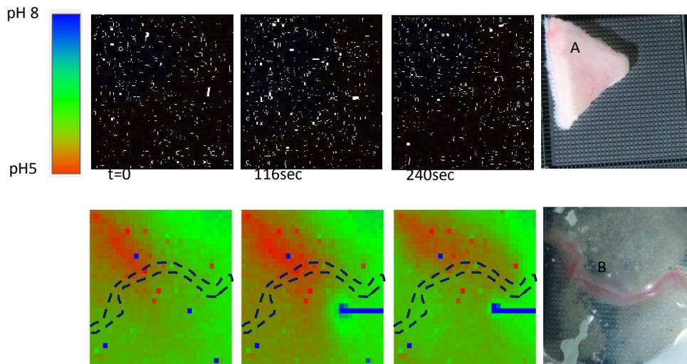
図3-1 2次元 pH イメージと IIS 上に静置した胃組織写真 (右)
