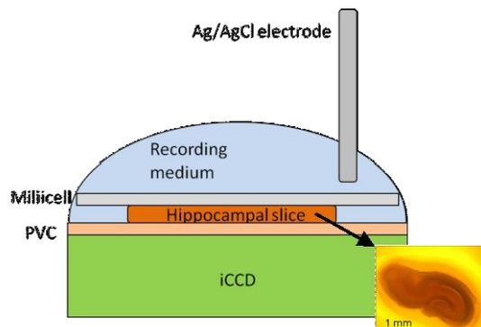
図3-2 カリウムイオンセンサの構成と脳スライス適用
