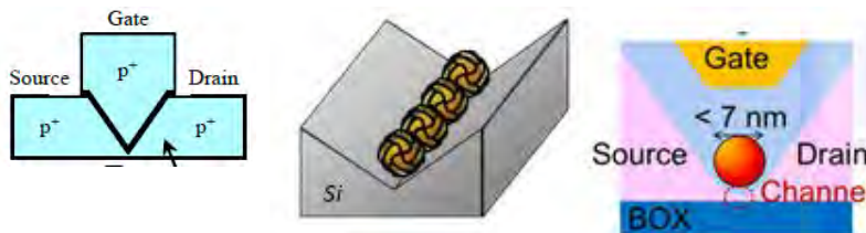
図 1-13 世界最短ゲートを持つ V 溝型トランジスタ
