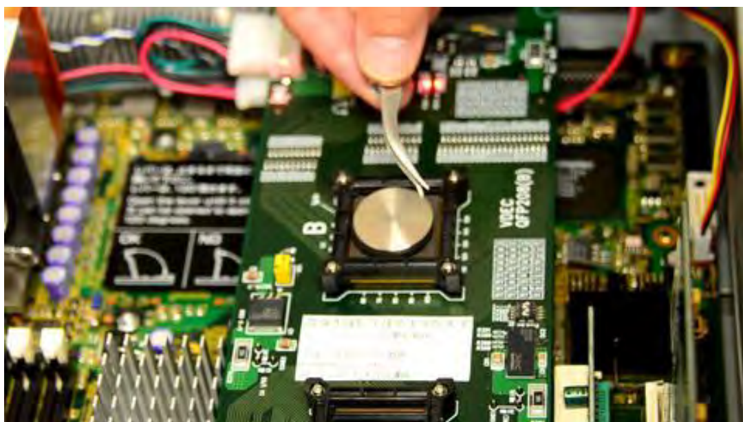
DARA の \alpha 線照射評価実験風景
