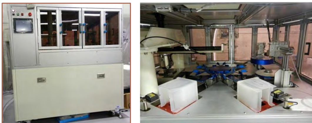
図8 ステップ&リピートUVナノインプリント装置の外観および内部
