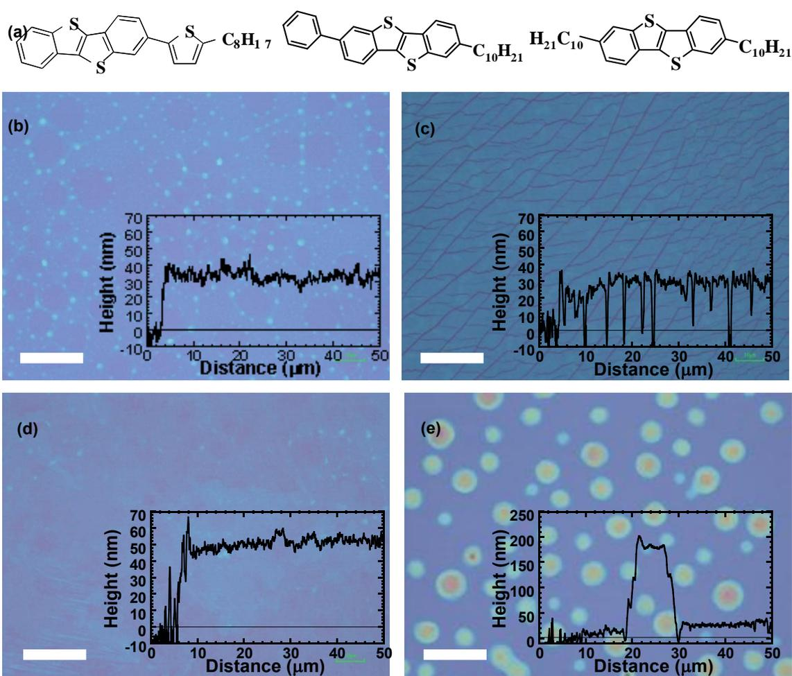
図 2 分子設計指針に基づいて設計した SmE 相を示す代表的な液晶物質を液晶温度でスピコート法により作製した多結晶薄膜(膜厚: ~50nm)の 150°C 5 分間加熱処理前後の偏光顕微鏡像と共焦点レーザ顕微鏡により測定した膜の表面プロファイル
