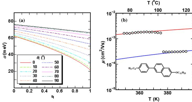
図8: エネルギーのディスオーダーの並進秩序依存性 8-PNP-012 の移動度の温度依存性。理論値(曲線)は実験値(プロット)を再現している。
