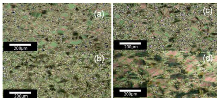
図 4 液晶ガラス相を示すトリエステル 20-PNP-8 の化学構造と液晶セル中で観察した各温度における偏光顕微鏡写真
