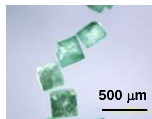
図 2-13 ZnJAST4 (核結晶) と CuJAST4 (膜結晶) からなる複合結晶
