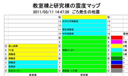
図7 各棟の震度分布図例(WEB公開)
