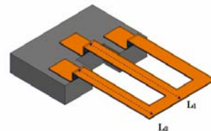
図 16 トリプルビームバイモルフの概略図
