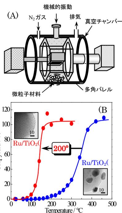
図2 (A) 多角バレルスパッタリング法の儀略. (B) 多角バレルスパッタリング法(Ru/TiO<sub>2</sub>(B))と従来法(含浸法: Ru/TiO<sub>2</sub>(W))で調製した触媒のCO<sub>2</sub>メタン化反応性能評価結果(挿入図は試料のTEM像).
