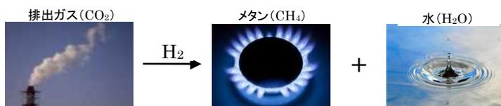
図1 CO<sub>2</sub>メタン化素化反応
