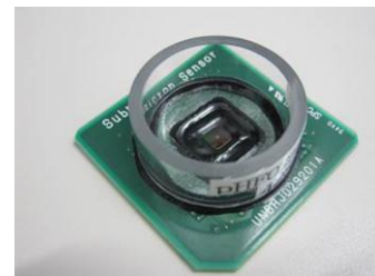
図 1: 1 次試作を終えた 2 \mu m ピッチイオンイメージセンサチップ
