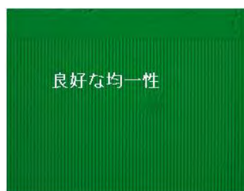
図 3:404nm 励起用 2 次 Q P M 分極反転構造
