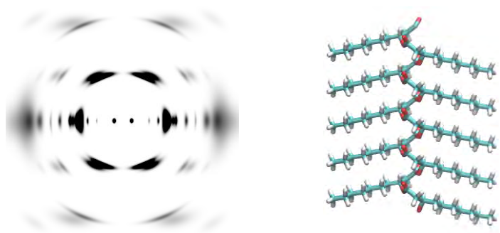
配向結晶性フィルムの広角 X 線繊維図と分子鎖構造
