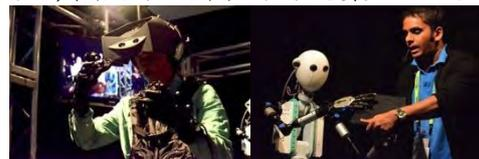
図 10: Telesar5 マスタコックピットとアバタロボット
