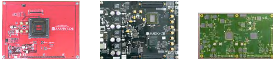
図4-5. サイドチャネル評価ボード SASEBO-RII(左), SASEBO-GIII(中), ZUIHO(右)
