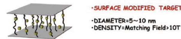
図3. 超伝導体への3次元人工ピン導入
