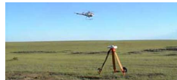
図5. ラジコンヘリコプター観測システム
