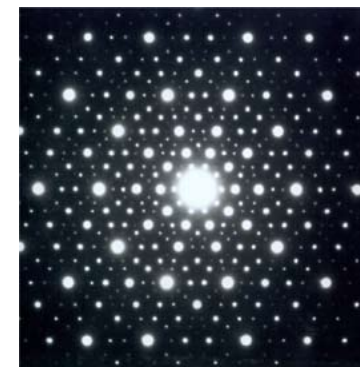
図4. 準結晶の5回電子線回折パターン
