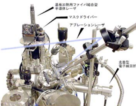
図2. コンビナトリアルレーザー成膜装置(CRESTで開発)
