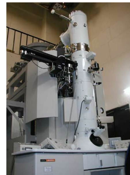
図5. 傾斜機構付き極低温電子顕微鏡
