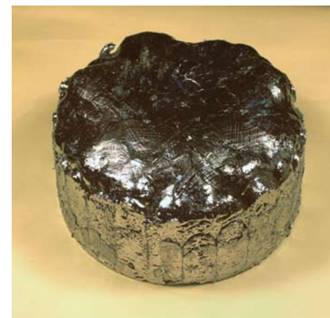
図3. 超高純度鉄の10kgインゴット
