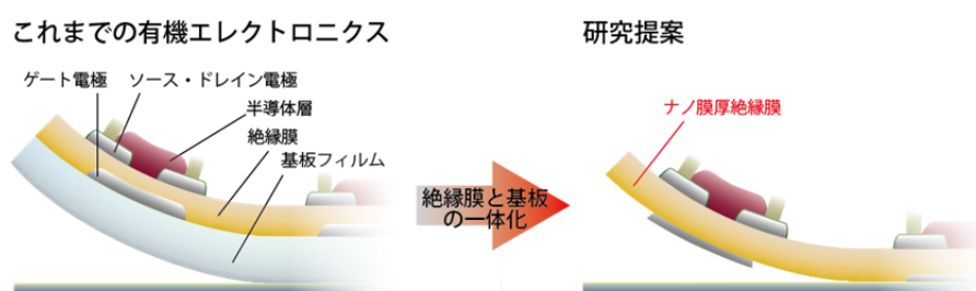
図 1: ナノ膜厚ポリマー絶縁膜を利用した全印刷型基板レス有機集積回路の創成の概略図。
