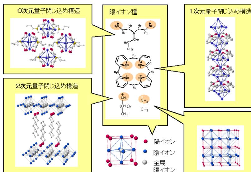
図 ペロブスカイト型有機・無機ハイブリッド化合物による、量子ドット(左上)、量子細線(右上)、量子井戸(左下)、およびバルク(右下)の構築例
