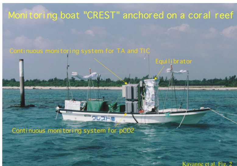
写真1 統合型 \text{CO}_2 計測システム「クレスト号」。 石垣島白保サンゴ礁において、1998年9月から1999年9月まで1年間の通年観測を行なった。電源は発電機で、日常のメンテナンスは地元の漁民に依頼した。
