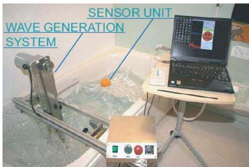
図12:加速度センサを用いた浴室内乳幼児溺れ防止システム(左)とその検証システム(右)
