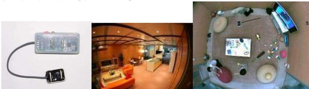
図1:乳幼児用小型筋電センサ(左)とロケーションセンサが取り付けられたセンサハウス(中央)と観察実験の様子(右)
