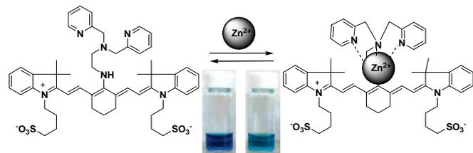
図 13 開発した近赤外領域蛍光発光 Zn<sup>2+</sup>プローブ
