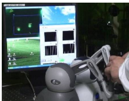
Fig. 4.1.6 左右の 3 次元力覚提示デバイスによる光駆動ナノマシン操作の様子
