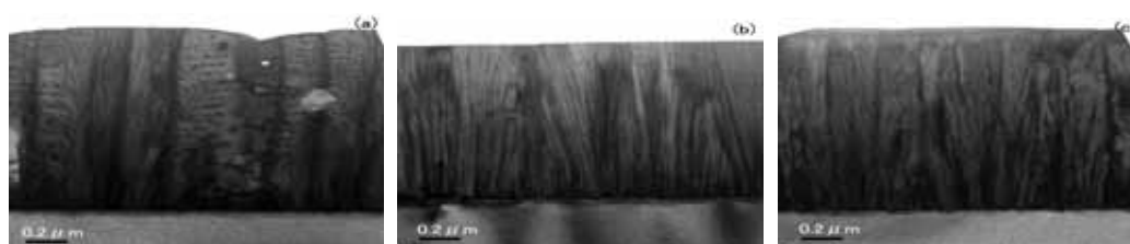
図 60 ナノロッドを含んだ YBCO 膜の断面透過電子顕微鏡像
