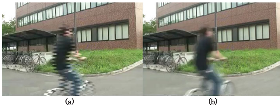
図 38 HD(1920x1035)サイズの映像を(a)単純間引き法と(b)フルエンシ法でそれぞれ QVGA(320x240)に縮小した結果の比較
