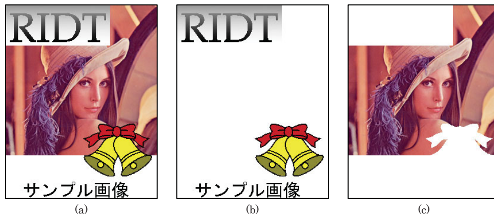
図 27 文字・イラスト・写真が混在する画像の自動分類例 (a)入力画像、(b)分類された文字、イラスト領域、(c)分類された自然画領域
