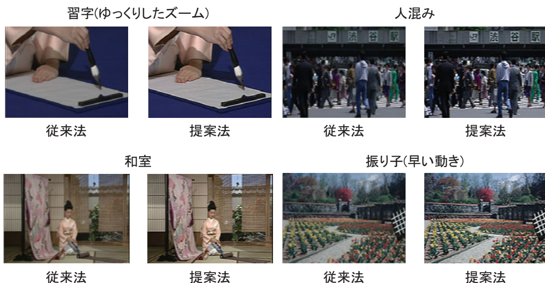
図 49 ノイズ除去におけるウィナーフィルタと提案法の比較 提案法は対象の動きの速さに関わらず、従来法より鮮明な映像を生成している。 (モーションブラーの大きさは動きの速さに依存し、ノイズ除去の性能に影響する)
