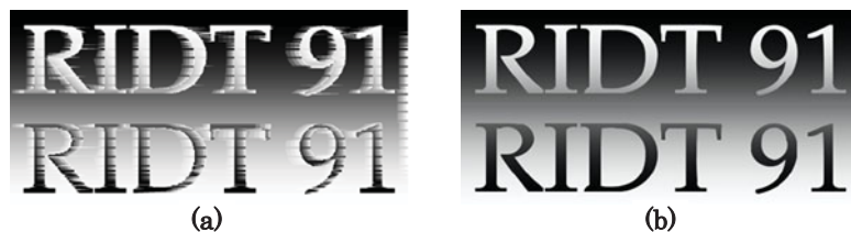
図 29 グラデーション画像(BMP, 24bits/pixel, 528x278, 430KB)を函数化した画像の比較 (a)従来法(単色領域函数化)[226KB]、(b)提案法(領域二変数函数化)[3.18KB]
