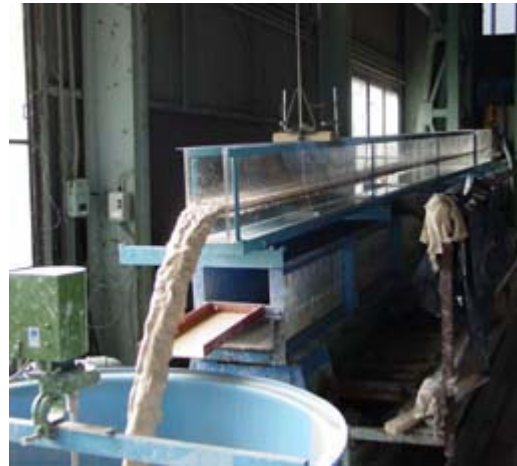
Photo. 3.4.1 循環水路における実験状況
