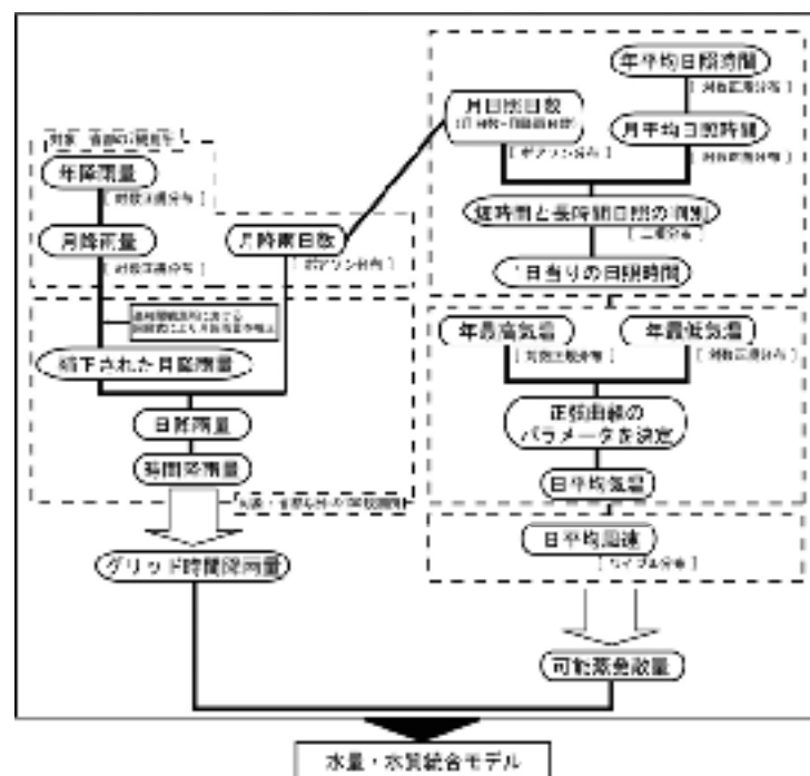
Fig.3.3.23 気象推測モデルの計算手順
