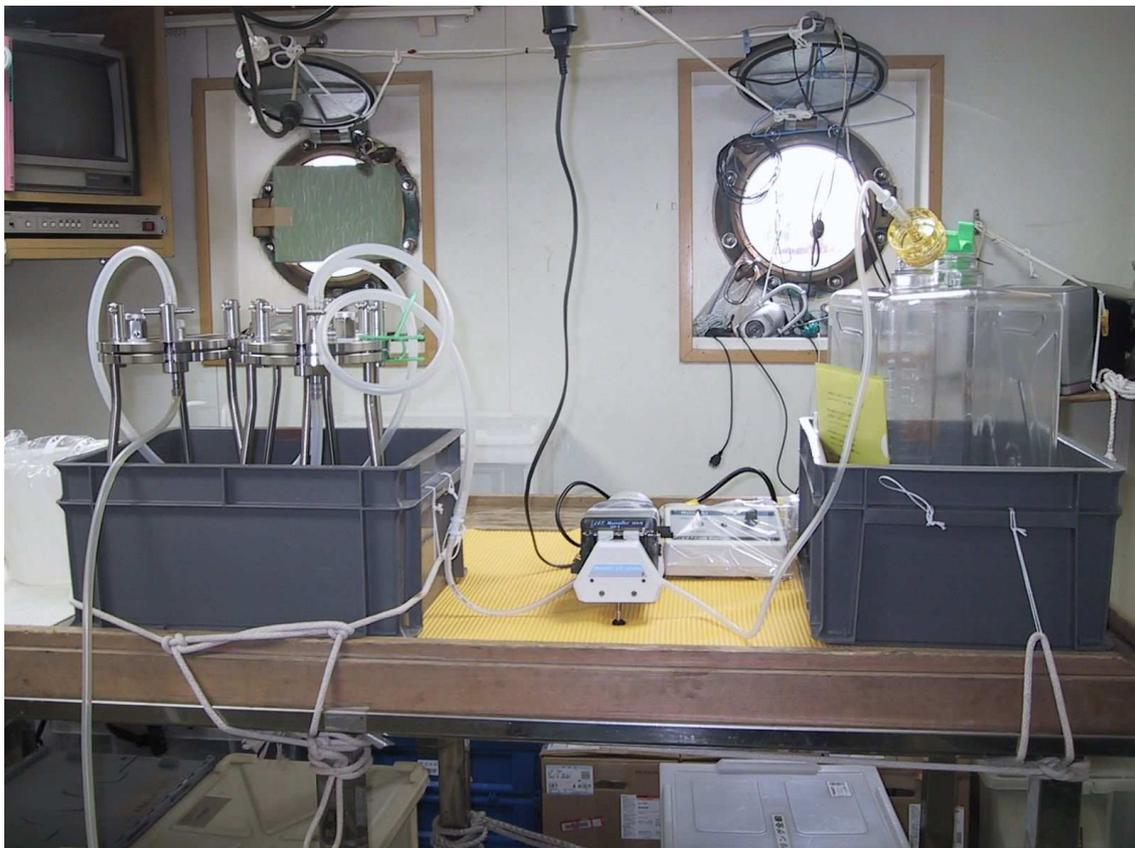
図1 メタゲノム解析用 DNA サンプル採取システム
