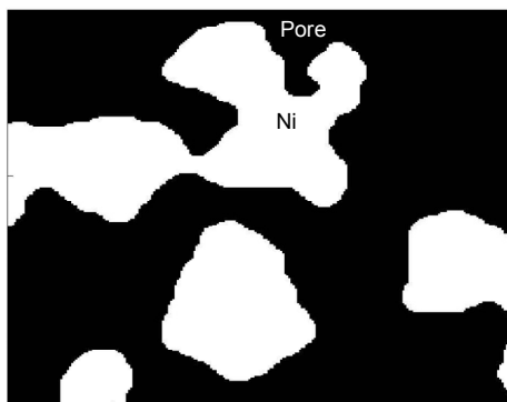
図 B-2 フェーズフィールド法による Ni 表面拡散計算
