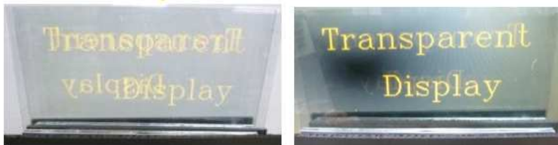
(a) : 透過状態 (文字が読めない) (b) : 指向性制御状態 (両面から文字が読める)
