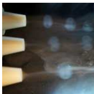
図1-1-3: 霧の渦輪による実体ディスプレイ
