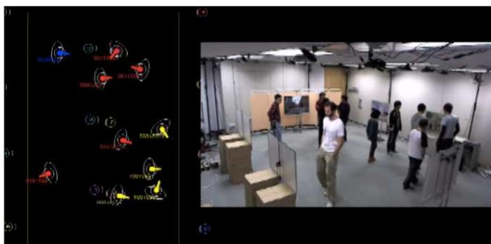
図1 3次元計測センサを用いた人の位置および体の方向の推定.
