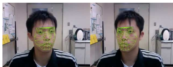
図 3 可変形状モデルを利用した顔特徴点の追跡
