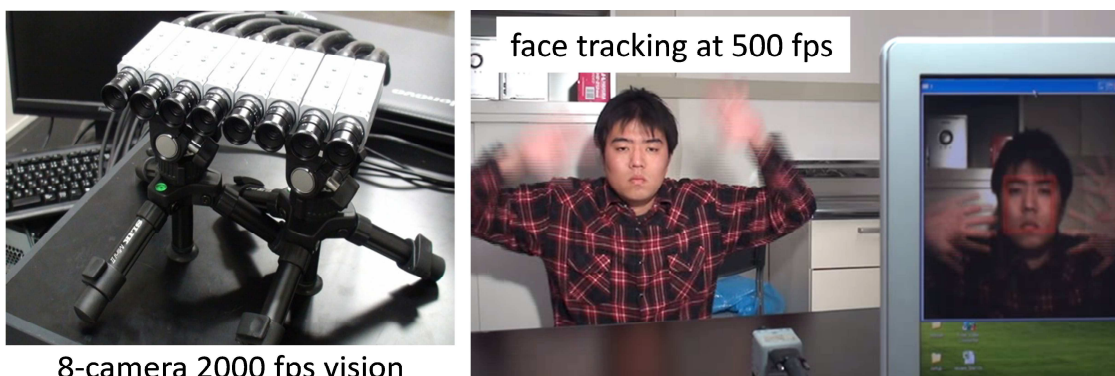
図 1 8 台の高速ビジョンモジュールと顔の高速追跡
