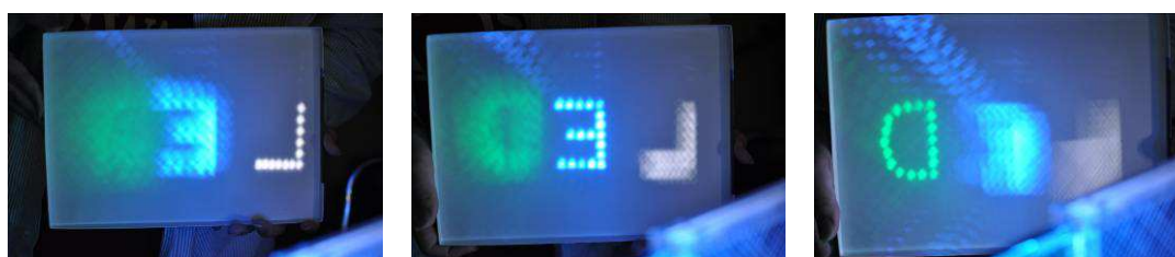
図 4 直交ミラーアレイにより空中に L, E, D が表示されている様子。
